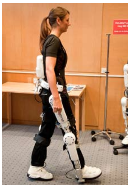
Signalerna förstärks av robotdräkten som hjälper till att röra benen.
